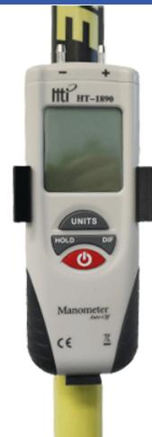
Manomètre différentiel avec attache pour enceintes de travail HepaZone
